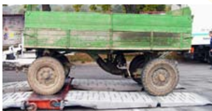
Technische Überprüfung eines Landwirtschaftsanhängers auf der Rüttelplatte des mobilen Prüfzuges
