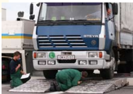
Bremsprüfstand eines mobilen Prüfzuges
