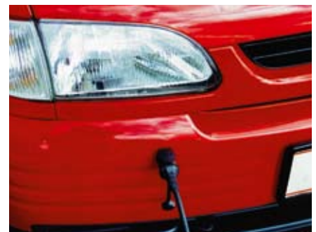
Elektrische Motorvorwärmanlagen benötigen einen Stromanschluss
