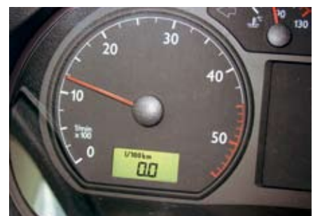
Wenn Sie das Gaspedal loslassen, wird kein Kraftstoff verbraucht.
