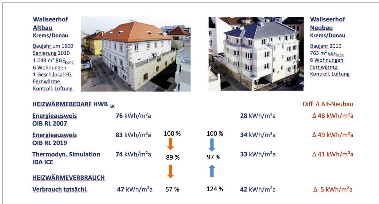
Abbildung 15: Vergleichsdarstellung von Heizwärmebedarf HWB lt. Energieausweisen nach OIB RL 6:2007 und 2019, Simulation nach IDA ICE und tatsächlichem Verbrauch 2011-2021 – Wallseerhof Krems (Graphik UWK).
