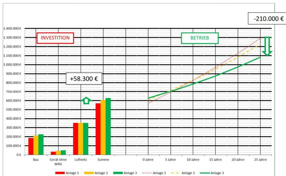
In Grafik 8 wurden zur besseren Gesamtbewertung den Errichtungskosten die Betriebskosten angefügt. Die Betriebskosten beinhalten alle für den Betrieb erforderlichen Wartungs- und Instandhaltungsaufwendungen und die für die jeweilige Anlage erforderlichen Energiekosten für Strom.
