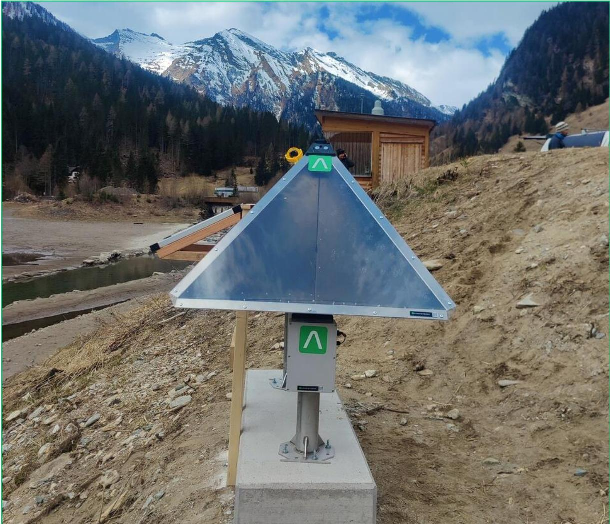
Abbildung 6: Corner Reflektor inkl. GNSS-Antenne und Messspiegel zur Verbesserung des Radar-Echos (Hangrutschungs-Monitoring, Salzburg AG, Hintermuh).
