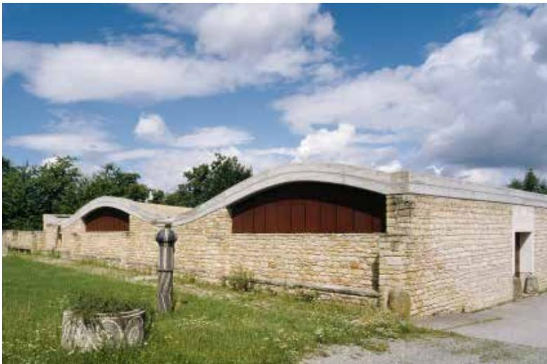
Die Fundamente, den Stahlbetonbalken und die Verlegung der Dachbalken führte die Sommerer Firma Hermann Hums aus. Das Steinmauerwerk wurde von drei türkischen Maurern errichtet – 60 cm stark. Alle Öffnungen, Türen, Tore und Fenster können mit Stahlblechen verschlossen werden. Wir heizen nicht. Die Luft kann durch die Halle streichen. Die Fenster haben bewegliche Stege, bei Schließung sind sie zugleich Einbruchschutz. Alle Details wurden mit den Handwerkern entwickelt.
