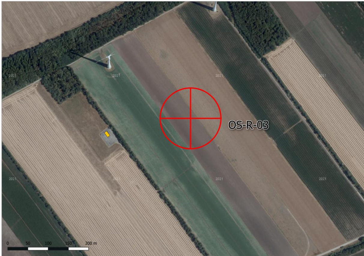
Abb 3: Darstellung der relativen Situierung der Anlage OS-R-03 und der Gas-Fördersonde der OMV. Die Größe des roten Kreises entspricht dem Durchmesser des Rotorüberstrichs und das gelbe Rechteck gibt die Dimension der Umzäunung um die Fördersonde wieder. Bei den im oberen Bildbereich im Luftbild erkennbaren Anlagen handelt es sich um Bestandsanlagen, die im Zuge des Repowering abgebaut werden. [Kartenquelle: basemap.at].
