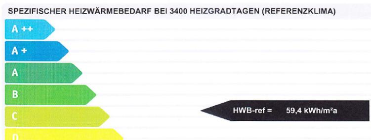
Abbildung 106: HWB von 59,4 kWh/m<sup>2</sup>a beim Beratungsobjekt in St. Pölten
